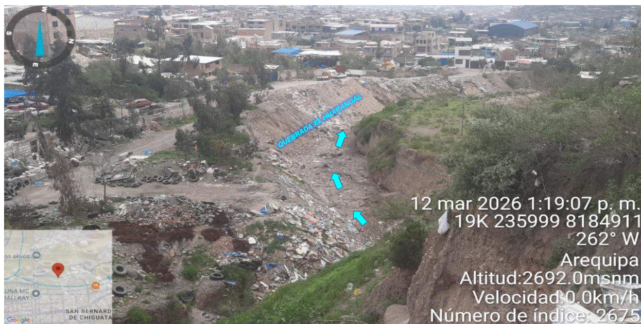
IMAGEN 02: EN ESTE TRAMO SE OBSERVA EN LA MARGEN IZQUIERDA DE LA QUEBRADA EL HUARANGAL, SU TALUD SE ENCUENTRA SIN PROTECCIÓN Y CON DESMONTE, Y VIVIENDAS CERCANAS A DICHA QUEBRADA.
